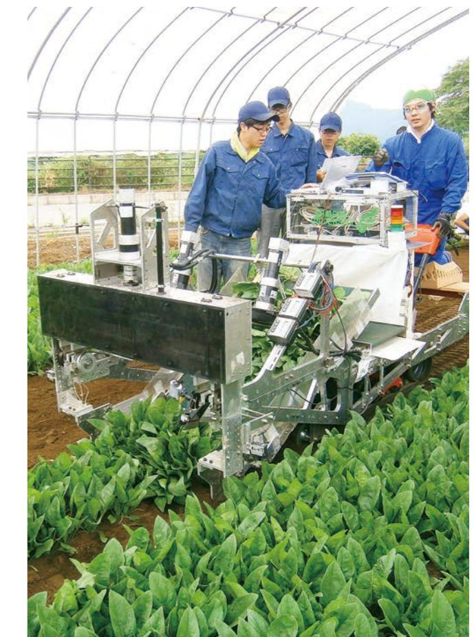
ホウレンソウをスピーディーに傷めないで収穫できる自動収穫装置（信州大学千田研究室）
