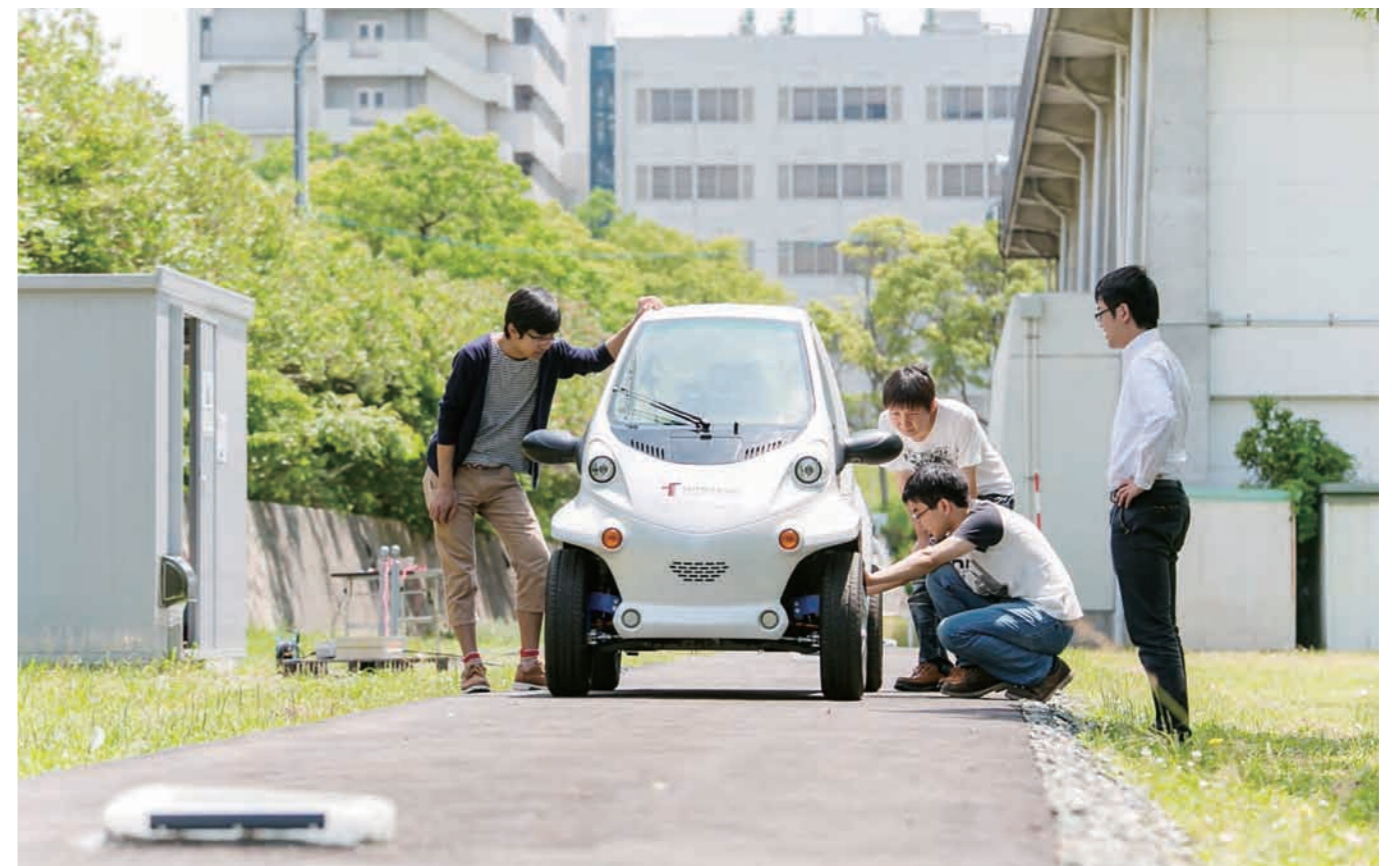
写真6 屋外ワイヤレス給電の走行実験の様子
