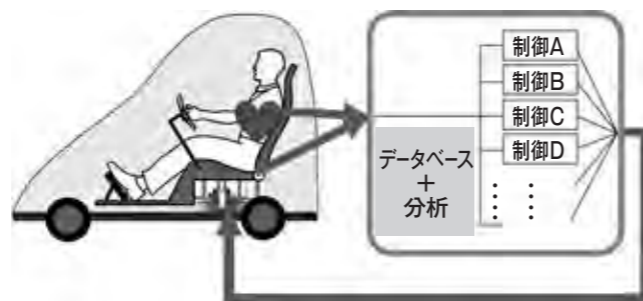
図2 運転者一人一人の乗り心地感覚をフィードバックする制御の概念図
